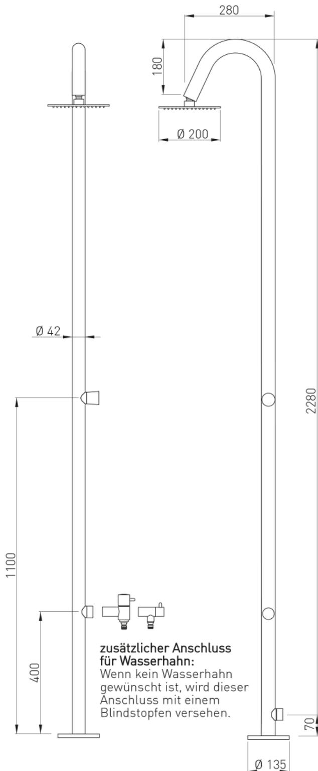
**zusätzlicher Anschluss für Wasserhahn:**
