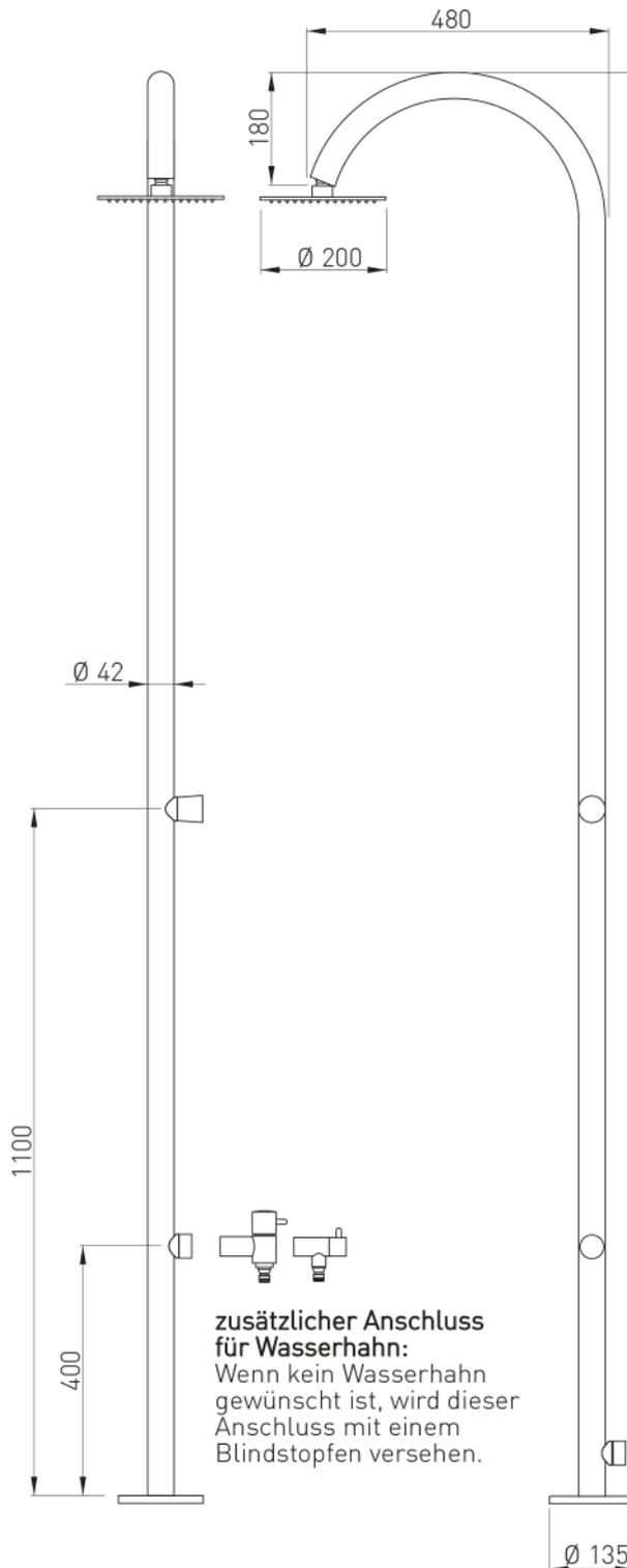
**zusätzlicher Anschluss für Wasserhahn:**
