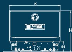
Ohne Hebe-Senk Automatik steht die CoverSeal 94 mm über dem Boden.
