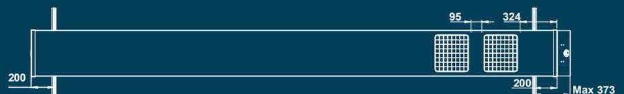
Der Überstand der CoverSeal beträgt bei der automatischen Version 200 mm auf beiden Seiten. Dieser lässt sich aber noch um 90 mm verkürzen auf einer Seite. Bei der halbautomatischen und manuellen Version beträgt der Seitenüberlauf von den Schienen 90 mm.
